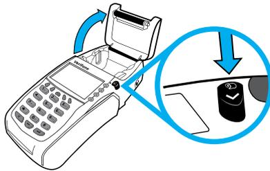
3. Retire los rollos de papel parcialmente usados de la bandeja de la impresora levantándola.
