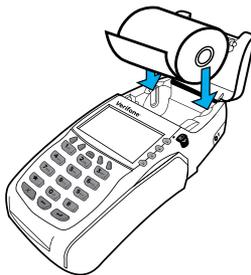
7. Cierre la cubierta del rollo de papel presionando con suavidad directamente sobre la cubierta, hasta que encaje en su lugar. Deje que una pequeña cantidad de papel sobresalga de la cubierta (tal como se muestra más abajo). **PRECAUCIÓN:** Para evitar dañar el rollo de impresión en la cubierta del rollo de papel, siempre cierre la cubierta presionando suavemente sobre la cubierta del rollo de papel.
